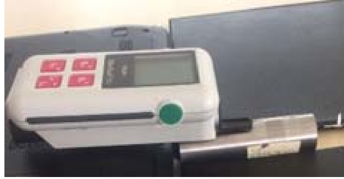
Şekil 4. Mahr yüzey pürüzlülüğü ölçüm cihazı
