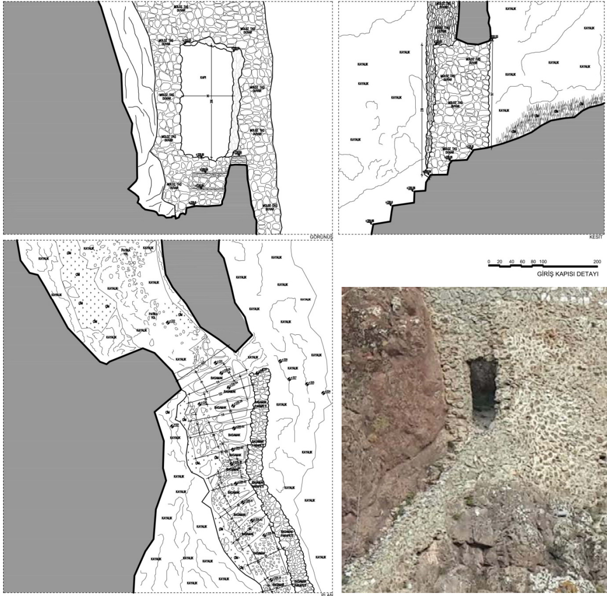
Şekil 85. Kalenin birinci kademe kapı detayı ve fotoğrafı (Rest. Uzmanı Y. Mimar Ömer Tavacıgil, 2015)
