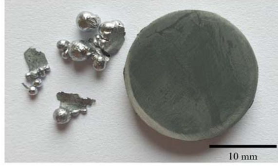
Şekil 6. Basınç destekli sinterleme sırasında kalıptan sızan sıvı faz ve elde edilen numunenin görüntüsü
