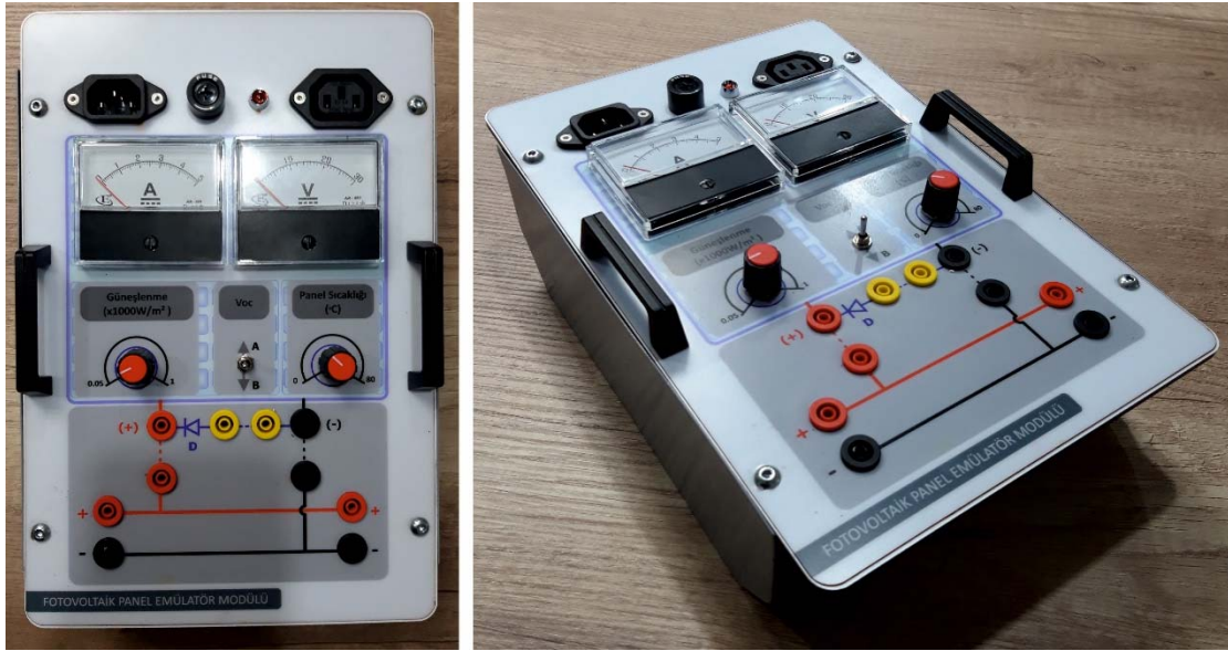
Şekil 4. Geliştirilen FV emülatörün görüntüsü
