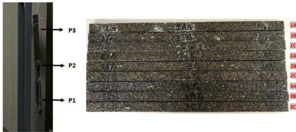
Şekil 45. Titreşim testlerinde kullanılan numuneler ve ivmeölçer yapıştırılma noktaları
