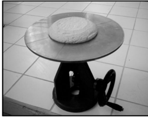
Şekil 1. Taze harcın akma tablasındaki yayılma durumu
