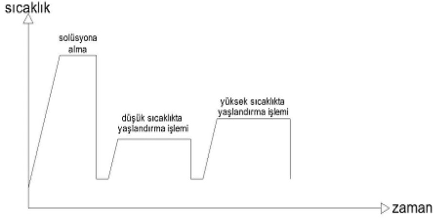
Şekil 1. Çift yaşlandırma ısıl işleminin uygulanması
