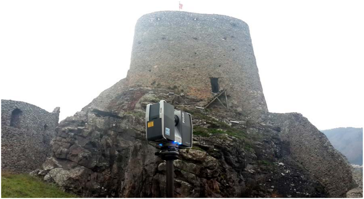
Resim 2. Yersel laser scannerla ölçüm çalışmaları
