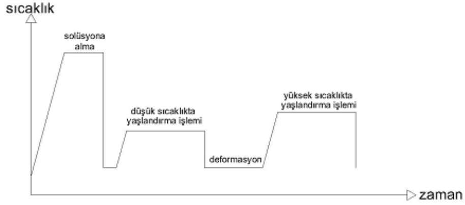
Şekil 3. Thermo-mekanik çift yaşlandırma işleminin ısı işlem profili
