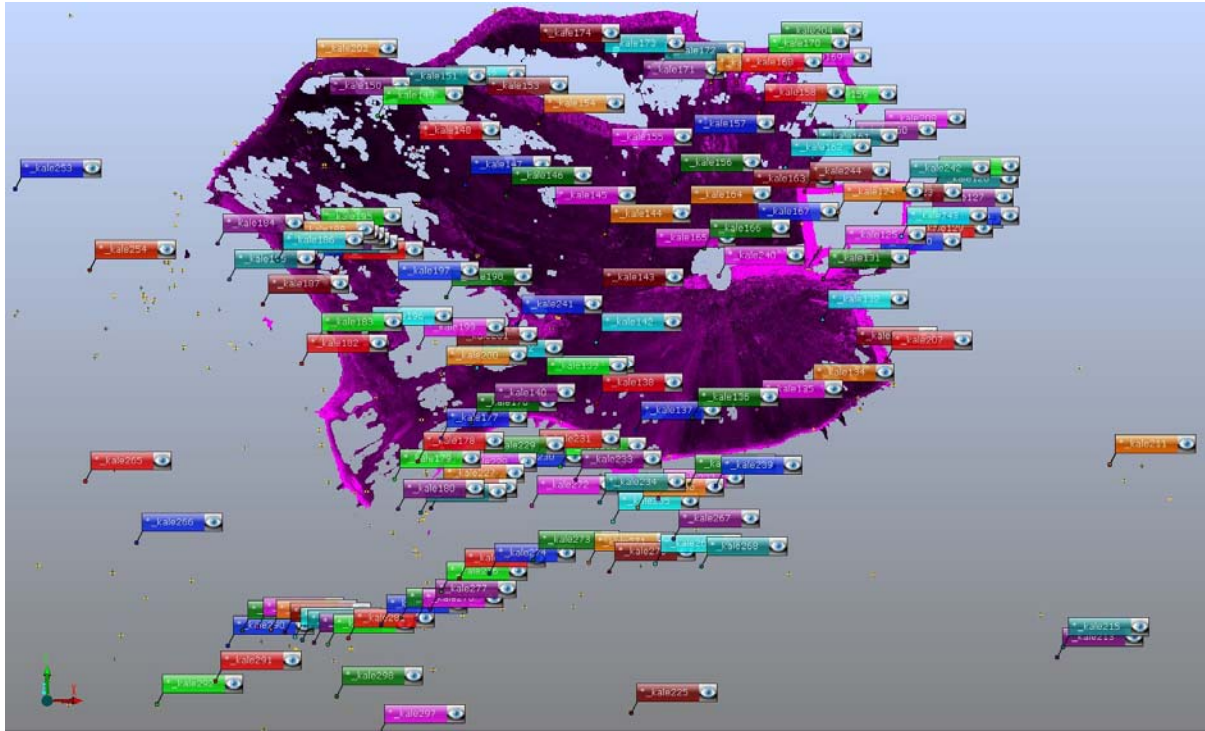
Şekil 75. Yersel laser scanner kurulumlarının yerlerini gösteren şema
