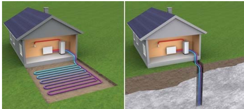
Şekil 4. Yatay ve dikey tipteki toprak kaynaklı ısı pompalarına ait uygulamalar [5]
